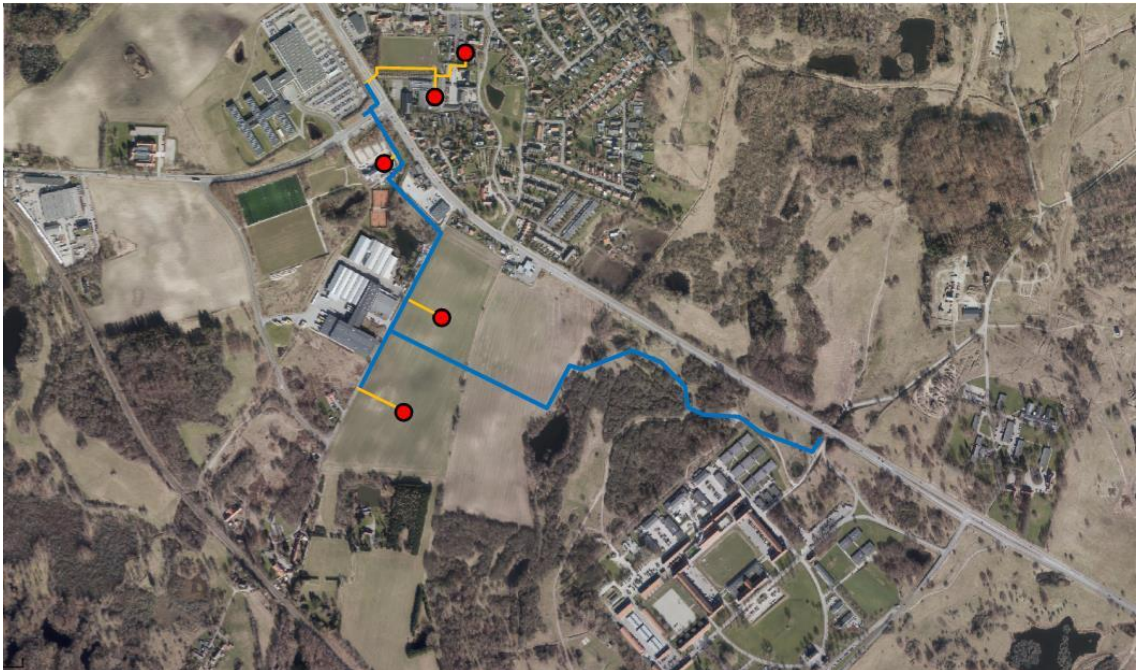
Figur 2: Blå = Forventet hoved- og forsyningsledning, Orange = Stikledninger
